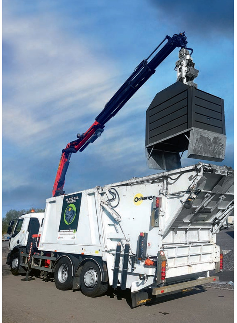
Le conteneur est vidé à l'arrière au moyen d'un dispositif de pliage intégré de type VP 128.
