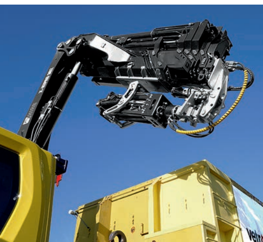
Appareil d'enregistrement avec grue radio intégrée Déchargeur de champignons VP 28 avec dispositif de pliage hydraulique, y compris frein pendulaire. Dispositif de pliage de type AFV 28.
